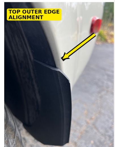
CONFIRM INSIDE EDGE + TOP OUTER EDGE ALIGNMENT
